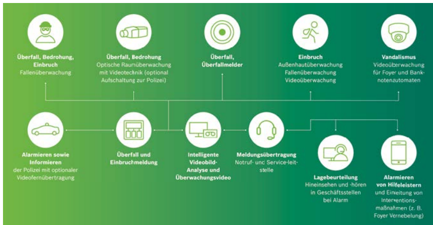
Ein Überblick über alle Schutzmaßnahmen, die eine Bank berücksichtigen sollte. © Bosch
